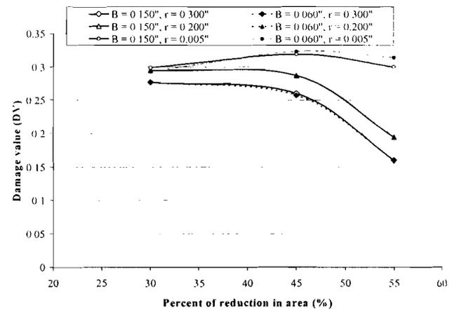
8. EFFECT OF REDUCTION RATIO ON DAMAGE VALUE IN SINGLE-PASS FORWARD EXTRUSION
