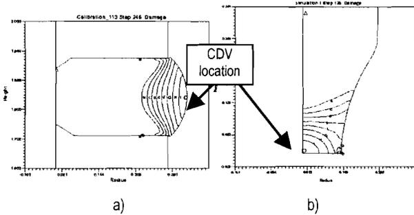
6. DISTRIBUTION OF THE CRITICAL DAMAGE VALUE FOR MATERIAL SAE 1137 (HOT ROLLED) A) NON-HOMOGENEOUS COMPRESSION AND B) NOTCHED TENSILE TEST.
