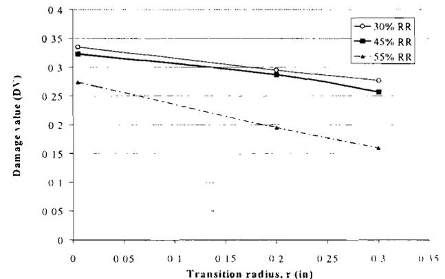
9. EFFECT OF TRANSITION RADIUS ON DAMAGE VALUE FOR SEVERAL REDUCTION RATIOS
